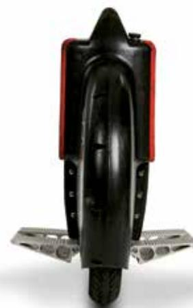
**Solowheel** – Monociclo, criado pelo designer chinês Shane Chen, é do tamanho de um assento de banqueta, pesa 9 quilos e, com apenas uma roda, é controlado pela inclinação do usuário. Tem autonomia de até duas horas e atinge 16 km/h. [www.solowheeluk.com](http://www.solowheeluk.com)
